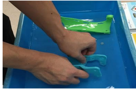
利用熱水將立體打印物料捲曲 (STEM 內容: 熔點、沸點)
