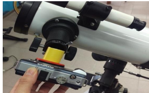
製作望遠鏡攝影機支架
